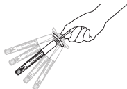
Zdjęcie 2: Resetowanie wartości temperatury termometru
