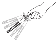
Slika 2: Ponovno postavljanje vrijednosti temperature toplomjera
