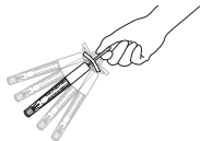
Slika 2: Resetovanje vrednosti temperature toplomera
