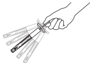
2. kép: A hőmérő hőmérsékleti értékének visszaállítása
