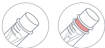
Slika 1: Pravilna namestitev kapilarne cevke in epruvete
