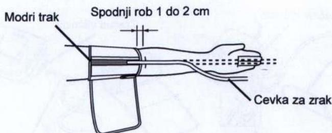
Manšeto namestite na nadlahet, tako da se bo moder trak nahajal na sredini notranje strani roke in bo usmerjen po roki navzdol. Cevka za zrak mora teči navzdol po notranosti podlahti in biti v isti črti kot vaš sredinec. Spodnji rob manšete mora biti približno 1 do 2 cm oddaljen od komolca.
